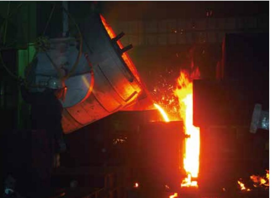
1,500度に熱された鉄を流し込み鋳造
