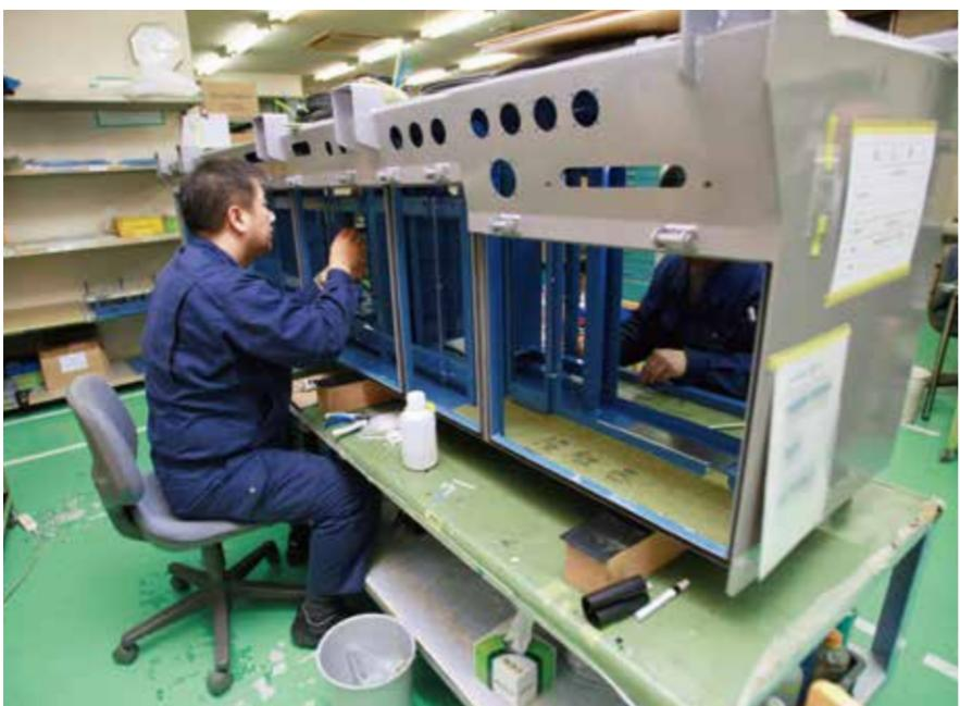
電車の車両に取り付ける装置の組み立て作業
