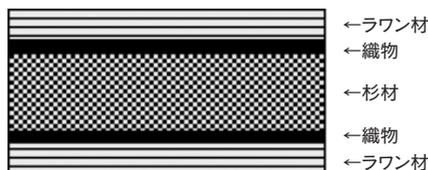
図2 強化木材の積層構成
