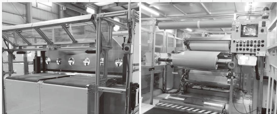
高評価を得た樹脂シート切断機(左)と巻き取り機
