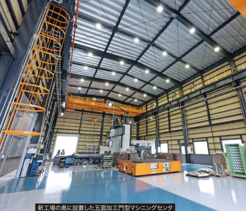
新工場の奥に設置した五面加工型マシンニングセンタ
