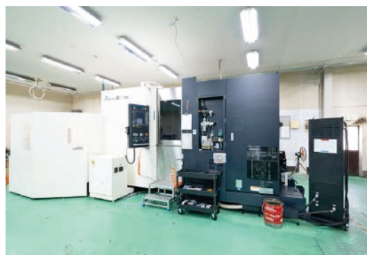
制度活用による設備導入例：24時間無人稼働仕様の横形マシニングセンター
