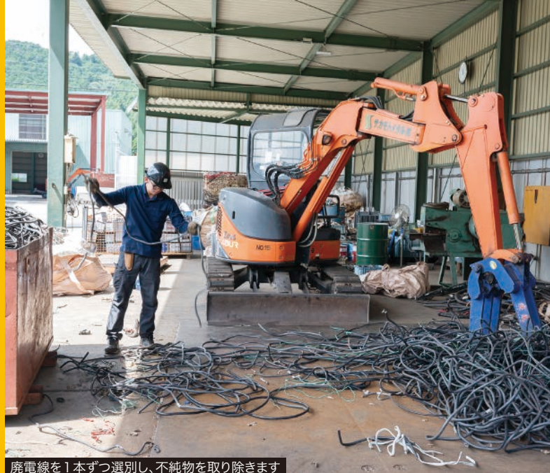
廃電線を1本ずつ選別し、不純物を取り除きます
