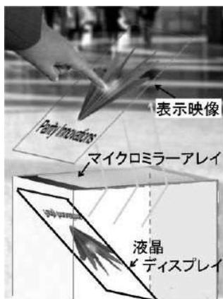
図1 空中映像表示システムの原理
