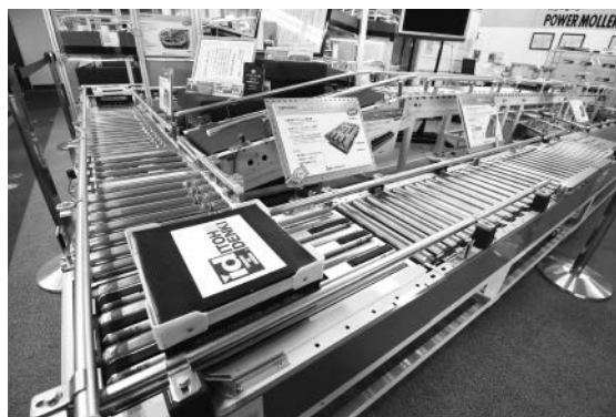
本社第一工場内に設置されているデモ用のパワーモラ
