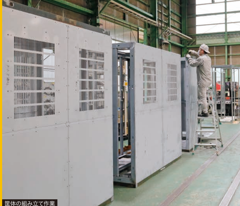
筐体の組み立て作業
