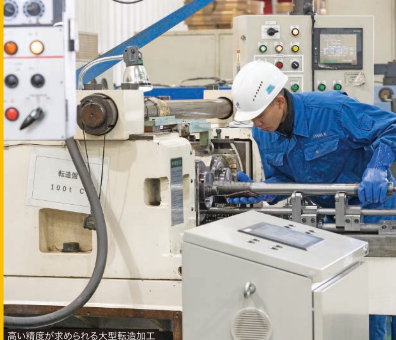
高い精度が求められる大型転造加工
