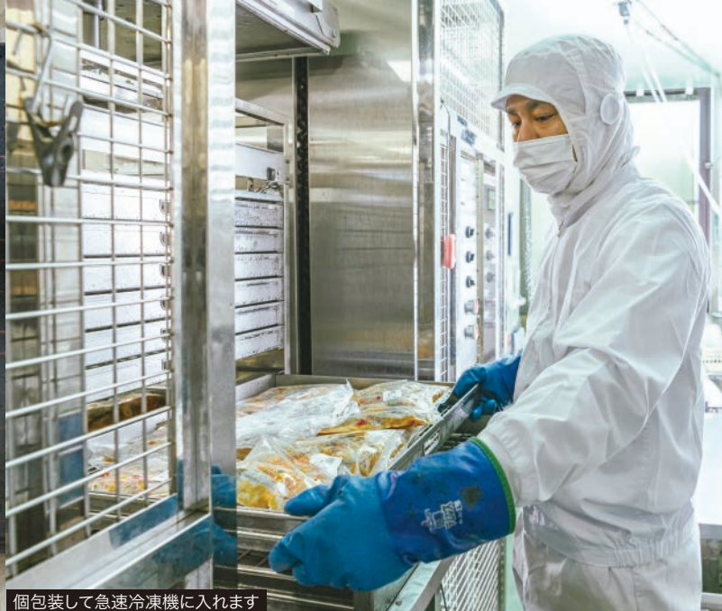
個包装して急速冷凍機に入れます
