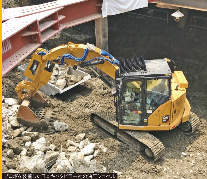
プロボを装着した日本キャタピラー社の油圧ショベル
