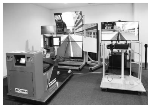
モリタテクノスが開発した「はしご車シミュレータ」。実車同様のリアルな挙動・操作感を体験できます
