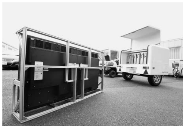
独自開発のパネルケース(左)とポータブル電力供給
