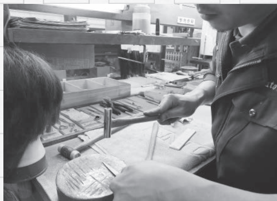
微妙なたわみ具合を金づちで調整する
