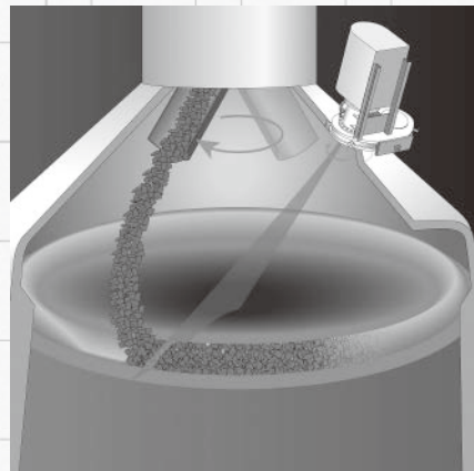
装入面を計測しリアルタイムで表示する「高炉3Dプロファイルメータ」
