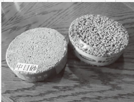
土を混ぜた舗装材(左)と石を混ぜた舗装材
