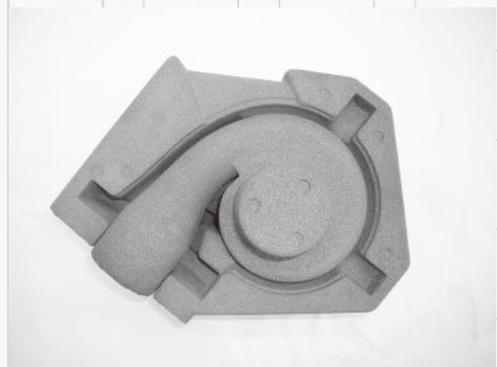
砂型は樹脂を混ぜた砂を焼き固めて出来上がります
