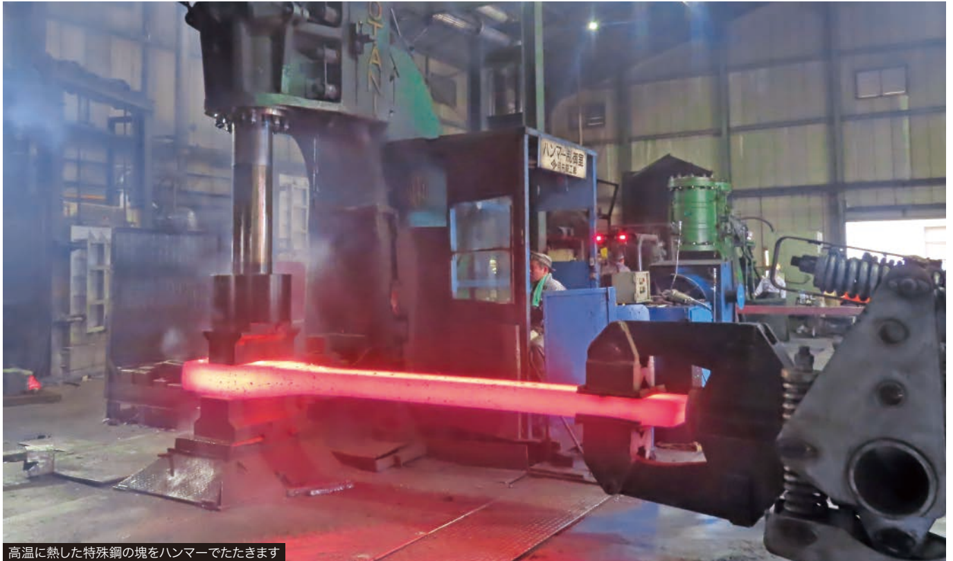
高温に熱した特殊鋼の塊をハンマーでたたきます
