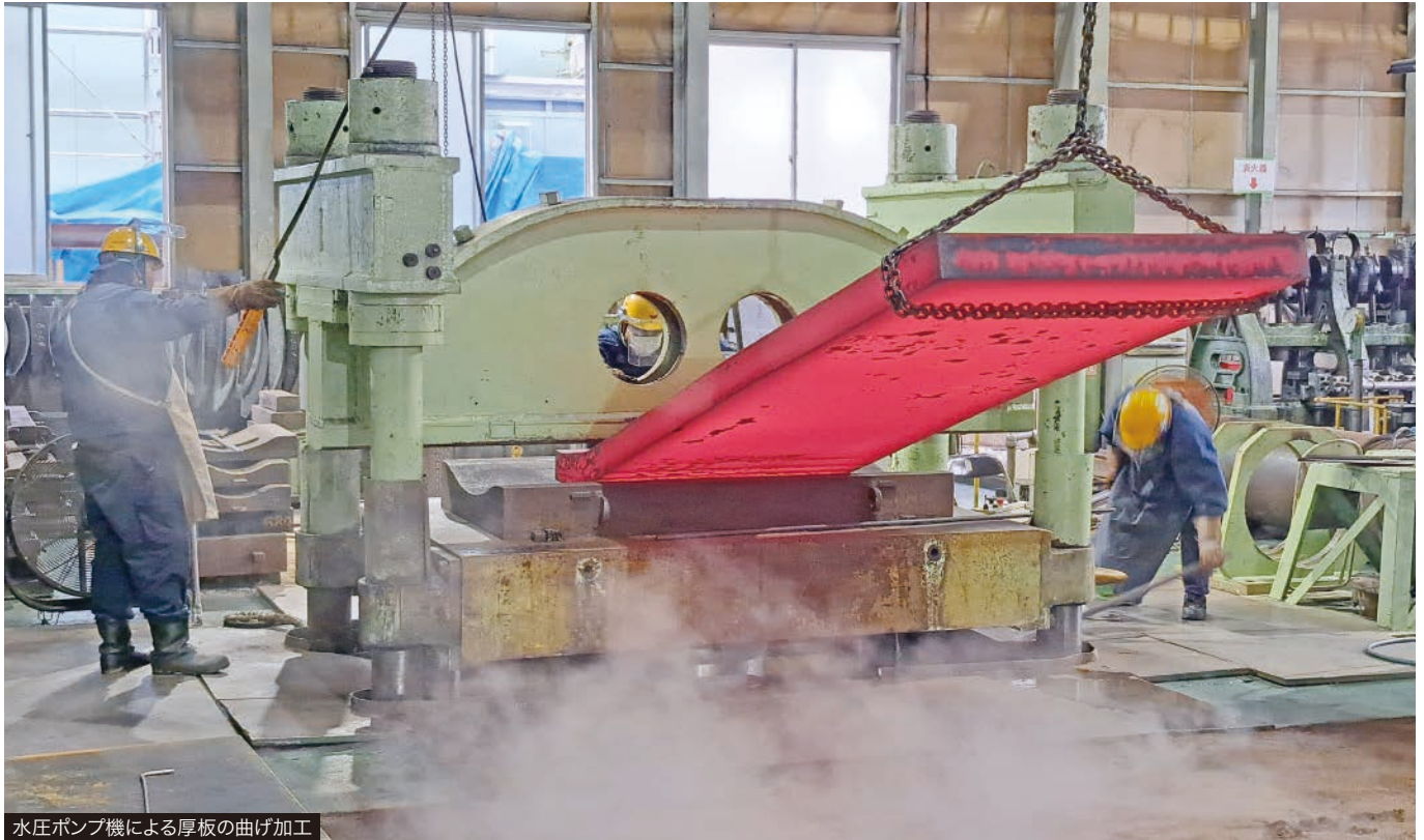
水圧ポンプ機による厚板の曲げ加工
