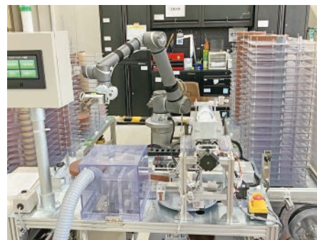
ロボット導入事業の契機となった吸着フィルターの製造装置
