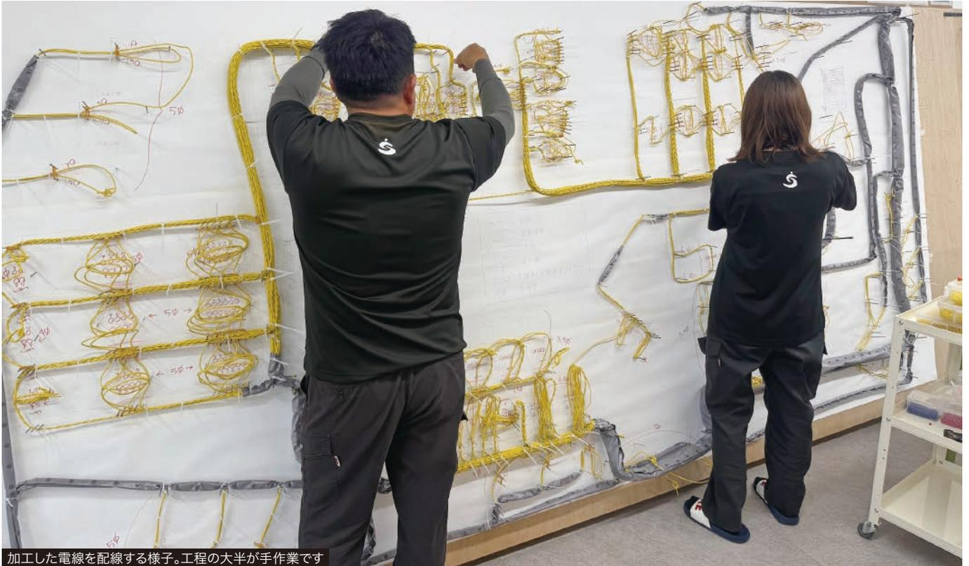
加工した電線を配線する様子。工程の大半が手作業です
