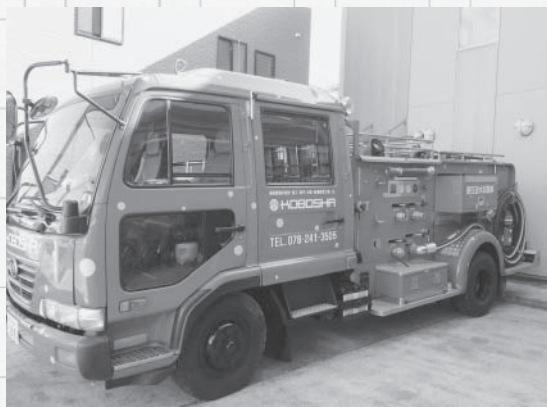
点検時、耐圧放水試験用に使われるポンプ車
