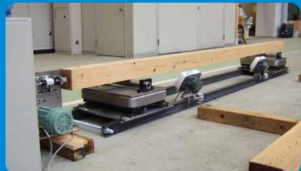
開発した木材強度計は、木材の曲げに対する強度を測定する装置で、機械等級区分構造用製材 J A S 認定に必要な全国木材検査・研究協会(全木検)の基準をクリアした装置として認定された。なお、製材工場が J A S 認定工場となるためには、実際に装置を使用して正確な強度測定ができるかどうかを試験し、全木検から資格を取得することが必要である。
